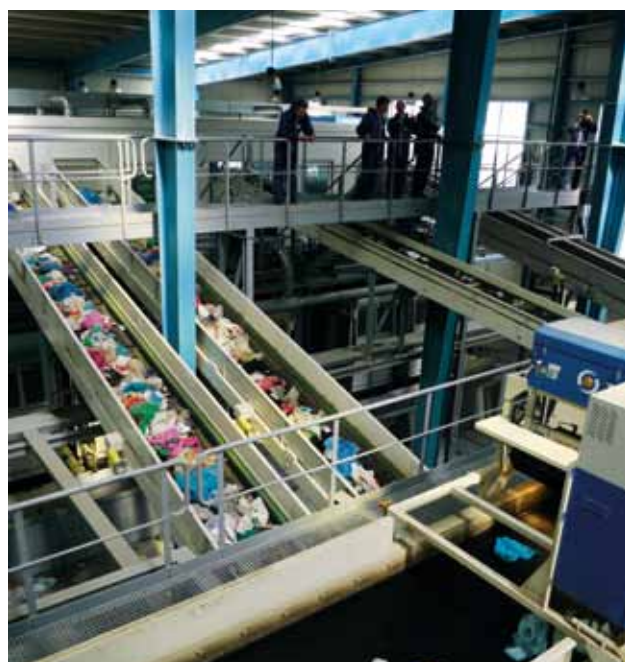
Sentralsortering i et sorteringsanlegg med NIR-teknologi i Larnaca, Kypros
