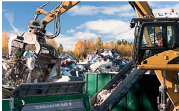
Kverning av brennbart avfall på sorteringsplaten på Bøler avfallsdeponi
