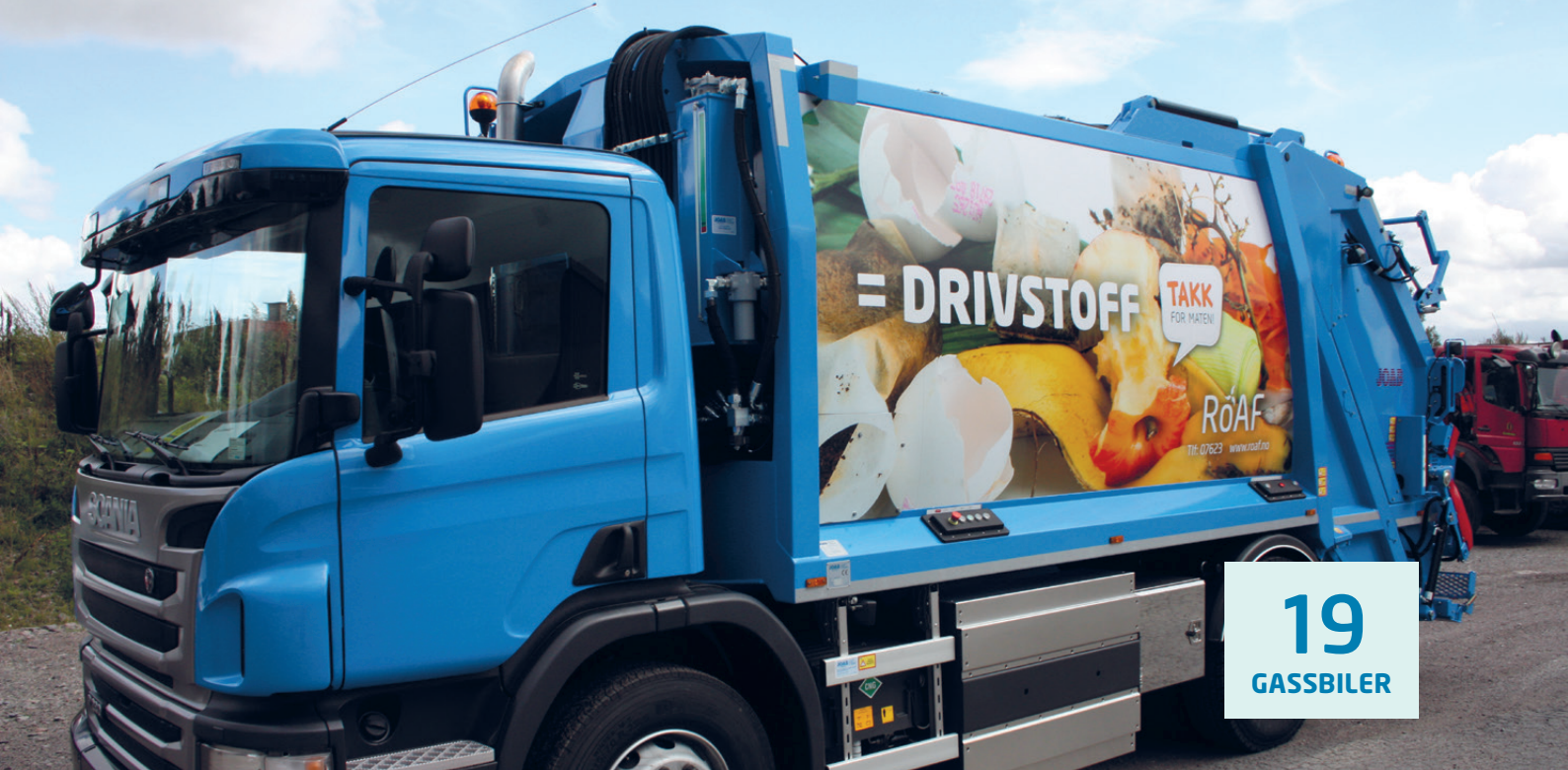
Renovasjonsbil som går på biogass laget av matavfall.
